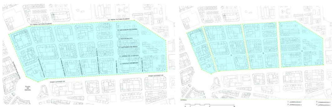
Figura 1. Calles incluidas en el ámbito de las supermanzanas (izquierda) y unidades de supermanzanas generadas (derecha).
