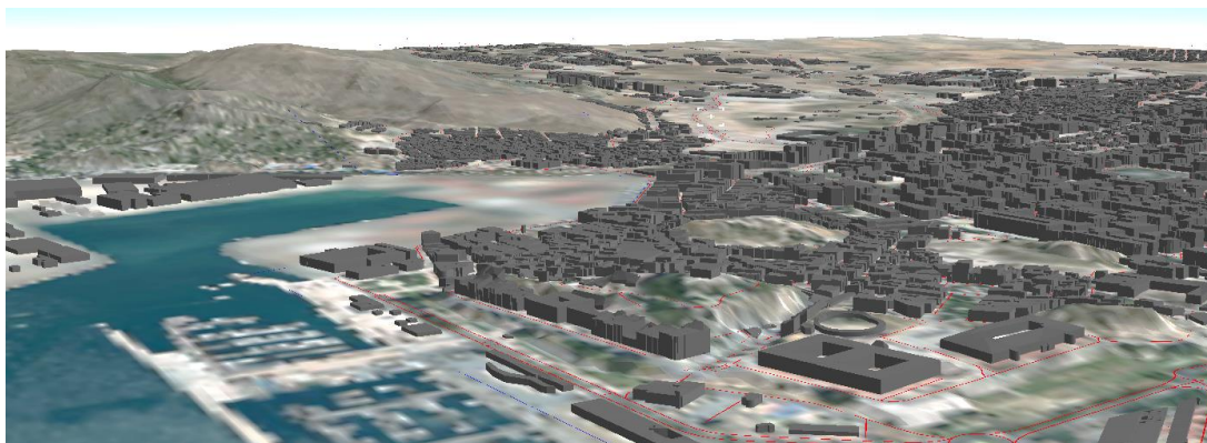
Imagen de modelado 3D en software predictivo IMMI
